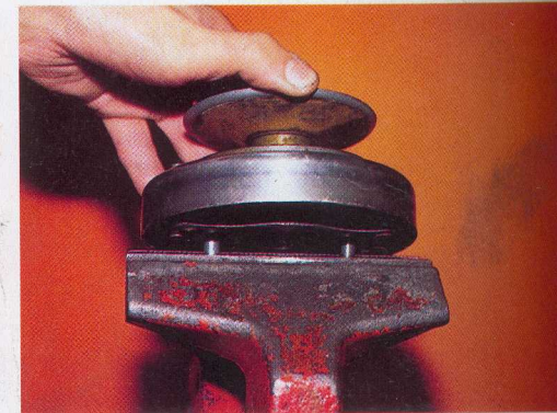
6 - Emboîter le moyeu de vario sur les deux tétons.
