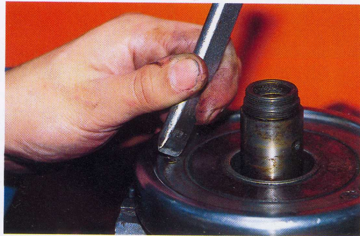
18 - Utiliser des vis neuves pour le flasque, et freiner les après serrage.
