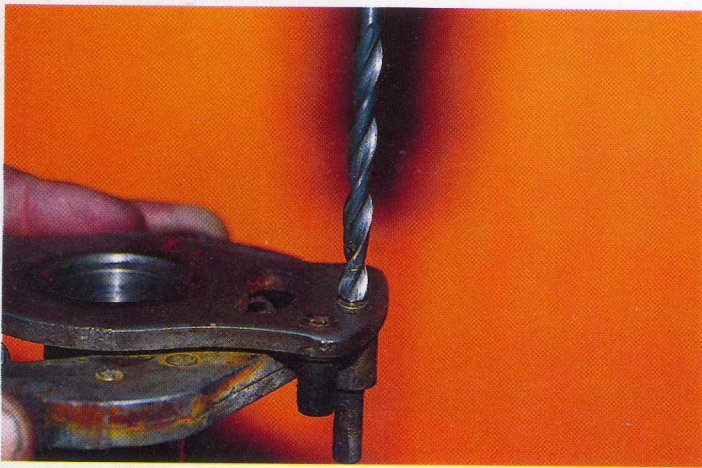
15 - Le point faible des varios MBK, les colonnettes de guidage. Lorsqu'elles sont usées, utiliser une perceuse pour les retirer.
