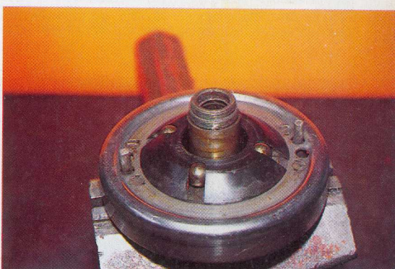
10 - Retirer la cage à billes et les billes. Il existe des cages 4 billes et des cages 3 billes.
