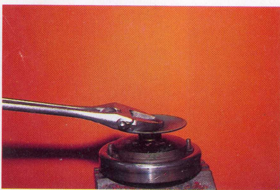
7 - Desserrer l'écrou de joue fixe. Attention c'est un pas à gauche.
