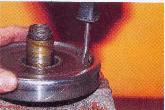
11 - Desserrer les 4 vis de fixation du flasque.
