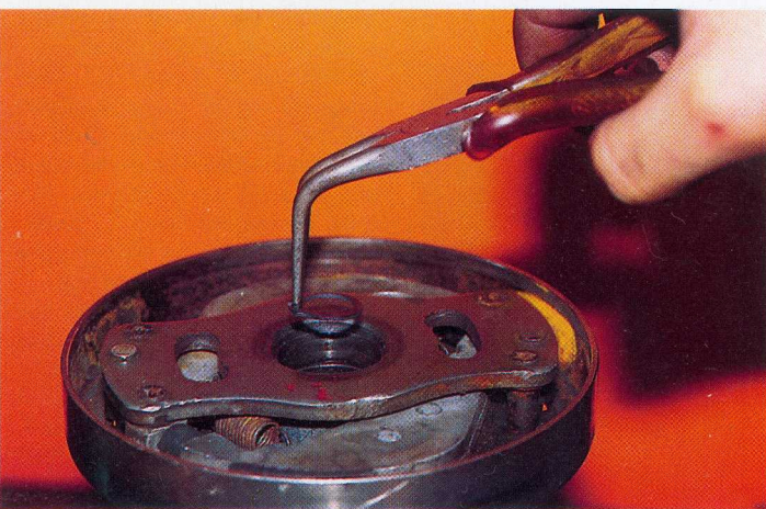
21 - Le circlips intérieur.
