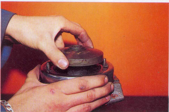
9 - Déposer la joue mobile. Mettre de la graisse dans celle-ci lors du remontage.
