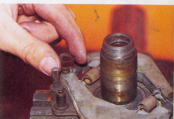
14 - Retirer les rondelles de calage de masselottes d'embrayage.
