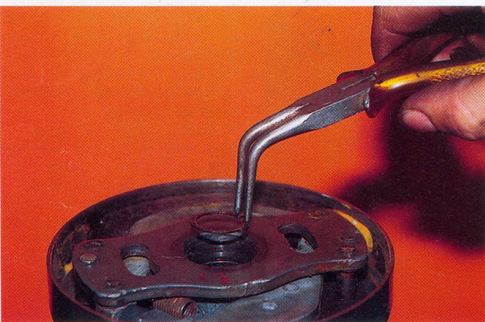
23 - Le circlips intérieur. Si toutefois les rondelles de calage avaient trop de jeu entre les deux circlips, on peut augmenter le nombre de celles-ci.
